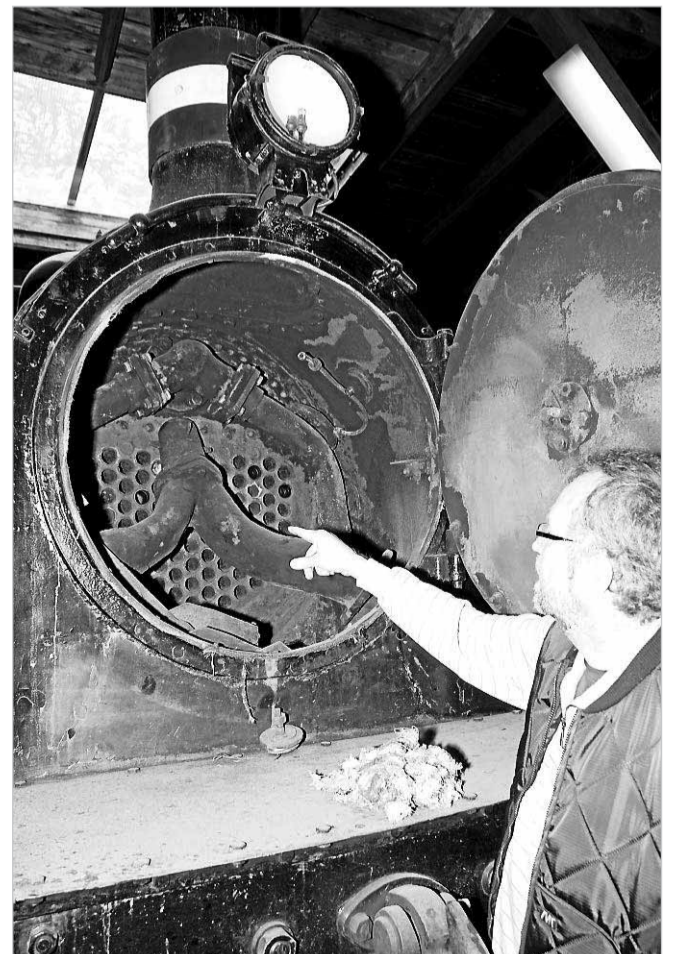
Damplokomotivets indre minder om en moderne varmeveksler.
